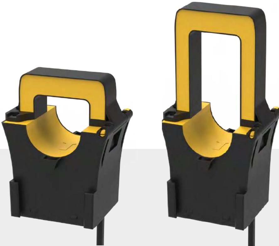
La serie de transformadores de núcleo dividido *STP* cubre un rango de corriente de 100 a 1000 A, dependiendo del modelo, y ofrece salidas secundarias de 1 o 5 A. Los modelos *STP 24* y *STP 40* tienen una ventana circular interna con diámetros de 24 y 40 mm respectivamente, mientras que el modelo *STP 40L* tiene una ventana rectangular de 40 × 80 mm.
