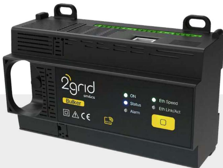
El dispositivo de monitorización para transformadores de potencia. Principalmente, mide los siguientes parámetros:
