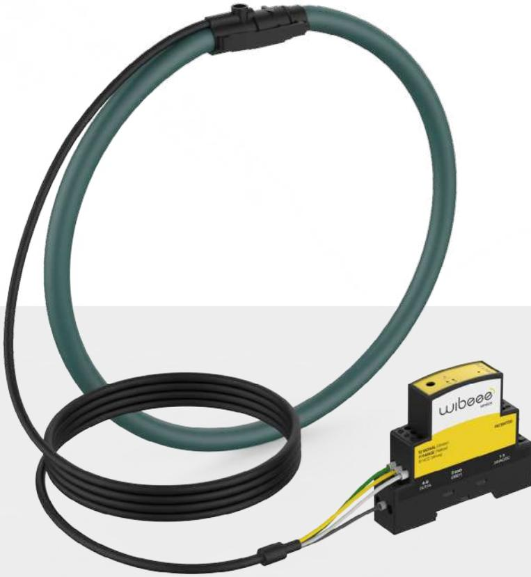
El *DIN Flex* es una pinza activa con un conversor diseñado para ir instalado en un carril DIN. Este conversor lo que hace es convertir la salida típica de mV de las bobinas Rogowski a una señal estándar .../1A compatible con dispositivos de medición o protección.
