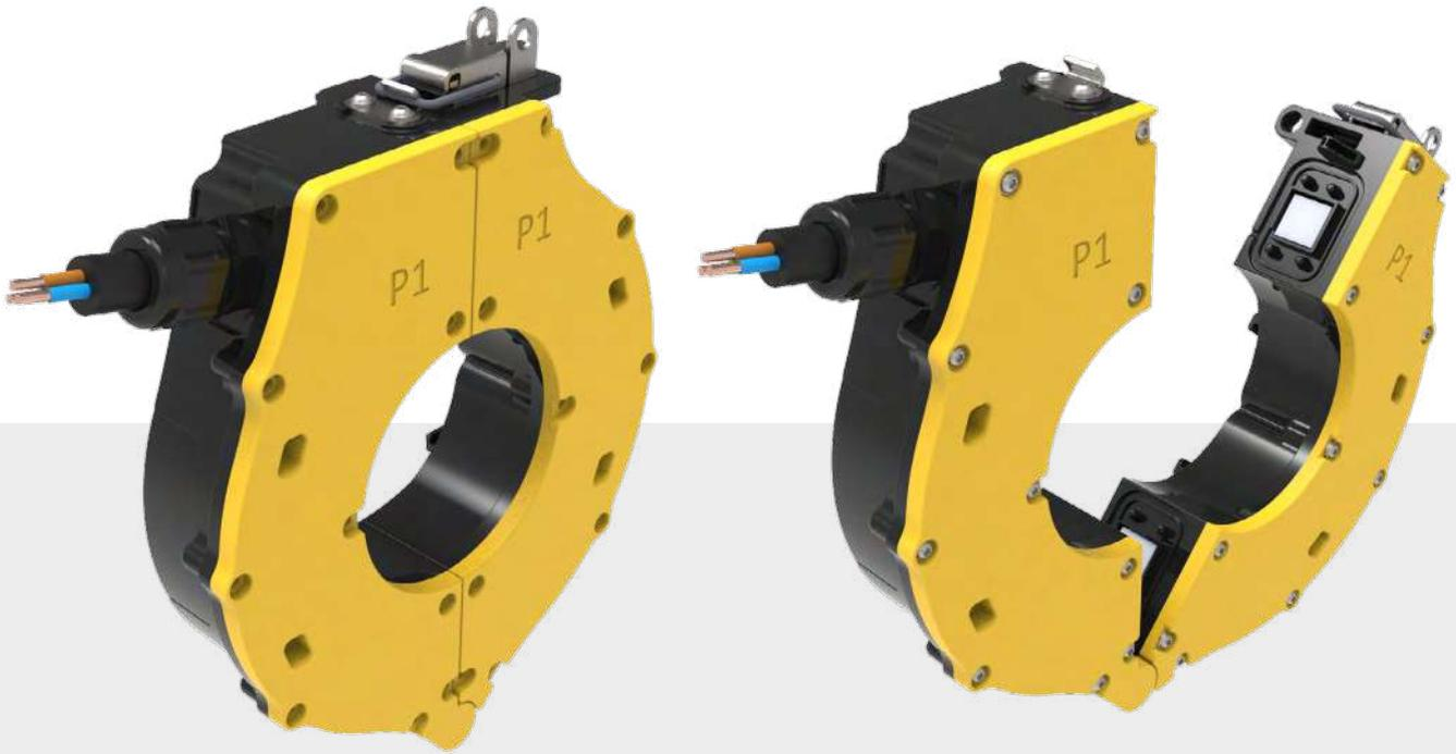
Los transformadores de núcleo dividido *Loop*, con un diseño circular y ventana interna, permiten instalarse en cables de hasta 55, 80 o 105 mm de diámetro sin necesidad de interrumpir el circuito primario, ahorrando tiempo y costos.
